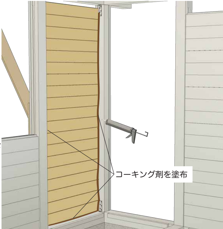
板壁と梁桁の間に 隙間が無いと最上段が 入らない
