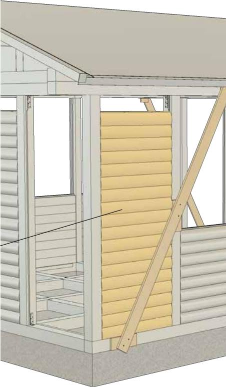
板壁を 18 段 落とし込む
