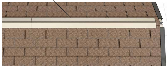
棟包下地材 (断面 12x90)
